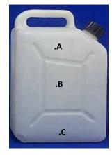
Proceso : SOPLADO Material : POLIETILENO DE ALTA DENSIDAD Color : NATURAL Tara  $: 600 \pm 30 \text{ g}.$ Capacidad : 10 L. Cámara de aire : 1300 cc. Resistencia Impacto: 1.2 m. Superficie : LISA : SIN OLOR EXTRAÑO AL PLÁSTICO Aroma
