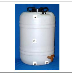
Proceso : SOPLADO : POLIETILENO DE ALTA DENSIDAD Material Color : NATURAL Tara : 2600 ± 5 g. Capacidad : 60 L. Cámara de aire : 5,4 L. Resistencia Impacto : 1.6 m. Superficie : LISA : SIN OLOR EXTRAÑO AL PLÁSTICO Aroma : 3 UNIDADES (BASE +2)
