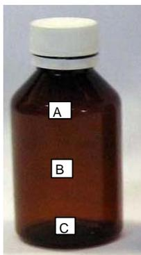
Proceso : INYECCION - SOPLADO
