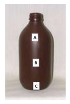
:SOPLADO Proceso Material : POLIETILENO DE ALTA DENSIDAD Color : CAFÉ Tara : 18 ± 1,8 g. Capacidad : 250 cc. Cámara de aire : 15 cc. Resistencia Impacto : 2 m. Superficie : LISA : SIN OLOR EXTRAÑO AL PLÁSTICO Aroma Apilamiento : N.A.
