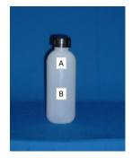
Proceso :SOPLADO Material : POLIETILENO DE ALTA DENSIDAD Color NATURAL: Tara  $: 8 \pm 0.8 \, \text{g}.$ Capacidad : 50 cc. Cámara de aire : 8 cc. Resistencia Impacto: N.A. Superficie : LISA Aroma : SIN OLOR EXTRAÑO AL PLÁSTICO
